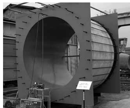
写真-4 SSP内圧管 (φ2,800mm管体内水圧0.6MPa試験状況)
