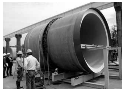
写真-1 4Mの水密試験状況 呼び径3000
