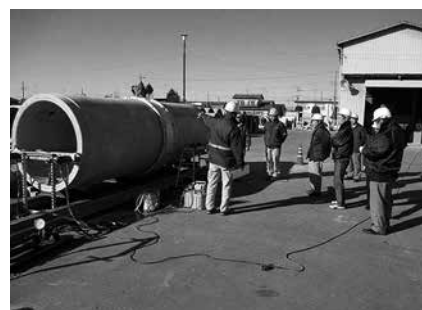
写真-3 0.3MPaの外水圧試験状況
