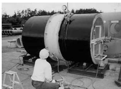
写真-2 6Mの水密試験状況 呼び径1350
