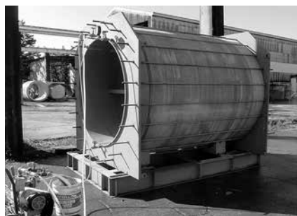
写真-4 内圧試験状況 呼び径2000
