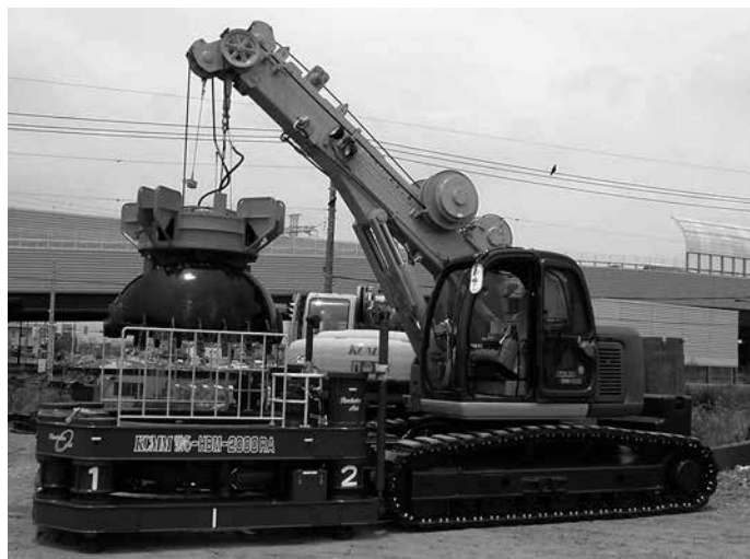
写真-1 最近の代表機械(左:全周回転型立坑機 HBM-2000RA)(右:カッティングロック HBM-5000CR)
