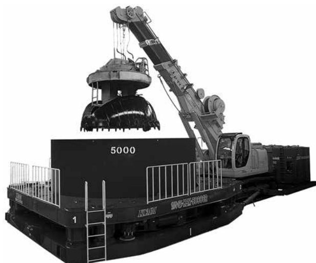
写真-1 最近の代表機械(左:全周回転型立坑機 HBM-2000RA)(右:カッティングロック HBM-5000CR)
