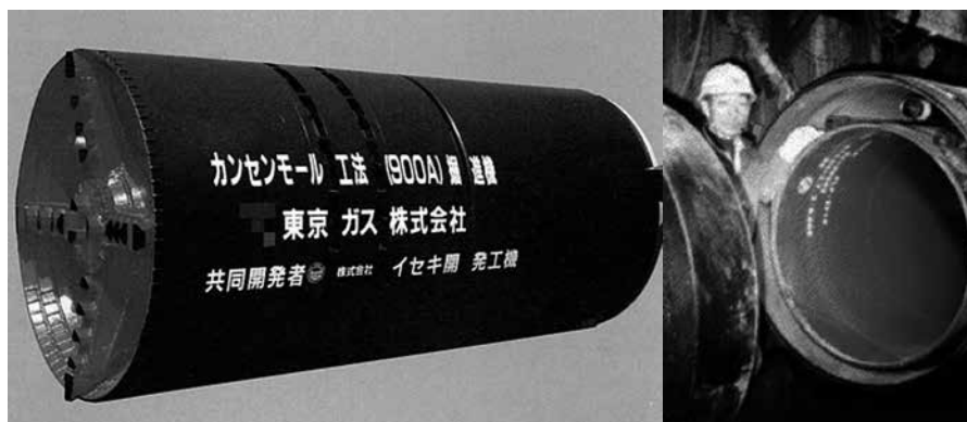
写真－1 カンセンモール工法掘進機と二重鋼管
