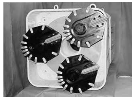
写真-1 ボックス掘進機1号機
