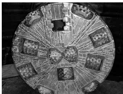
写真-2 到達後の掘進機面板
