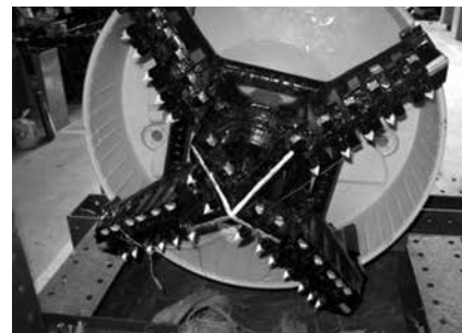
写真-3 ファイバードレーン切削用掘進機
