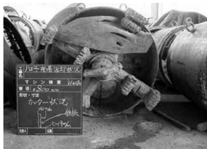
写真-1 支障物（洗掘防止の橋脚根入保護用残置鋼矢板）切削後の回収された取込型掘進機
