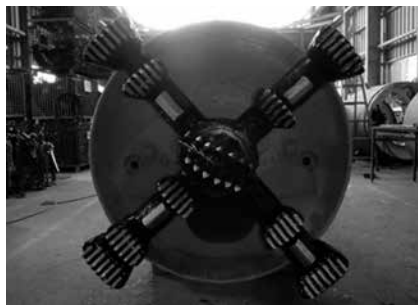
写真-2 支障物切削対応用取込型掘進機
