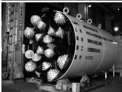
写真-2 岩盤・巨石破碎型推進工事（ \phi 700 \sim 1,650\text{mm} ）
