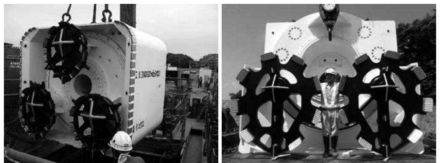
写真-5 ボックス推進工事（雨水渠、地下歩道等）（内空断面 \square 3,000 \sim 2,000\text{mm} 程度）（左： \square 2,400 \times 2,000\text{mm} 対応掘進機、右： \square 3,000\text{mm} 対応掘進機：分割搬入現場組立）
