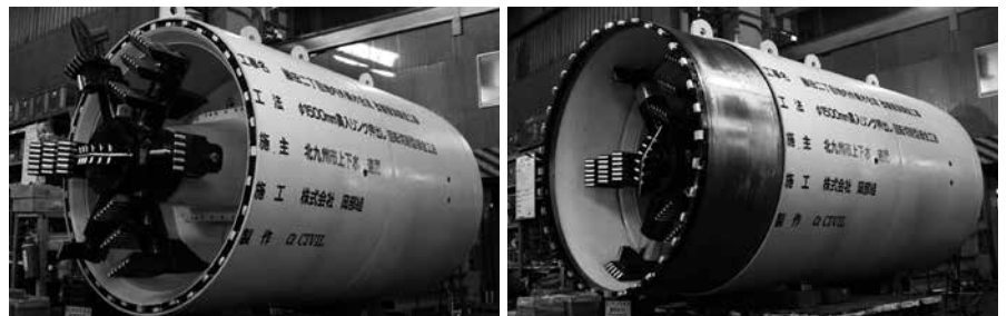
写真-4 既設シールド、マンホール、構造物への管きょ直接接合工事（左：通常推進時、右：構造物への接合時）（ \phi 800 \sim 1,500\text{mm} ）
