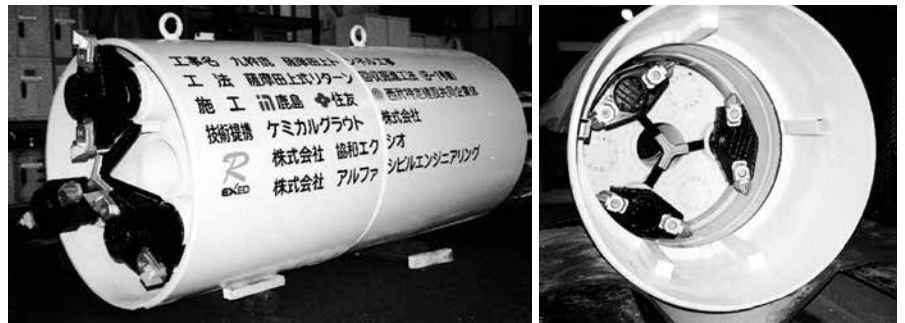
写真-3 中口径長距離パイプルーフ工事（左：全景、右：引戻中）（ \phi 812 \sim \phi 1,016\text{mm} 鋼管）
