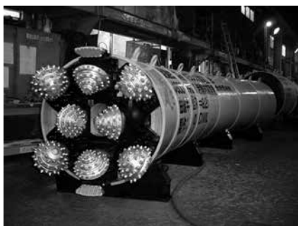
写真-1 平面・縦断路線の急曲線推進工事（ \phi 800 \sim 2,400\text{mm} 程度）
