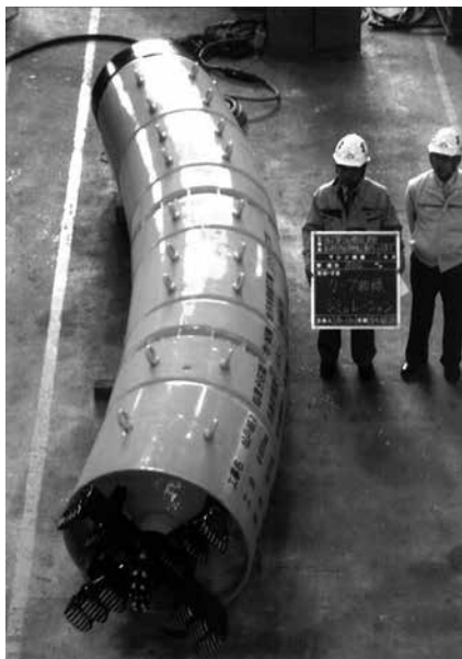
写真-1 平面・縦断路線の急曲線推進工事（ \phi 800 \sim 2,400\text{mm} 程度）
