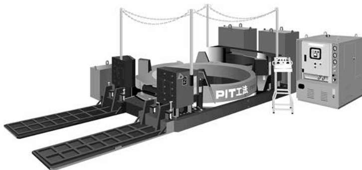
写真-1 PIT立坑構築機
