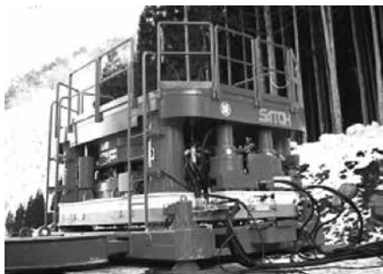
写真-1 アート工法機の原型となった 三和機材(株)製 ロダムRB-200型 全周回転掘削機 掘削径：φ1,500～2,000mm 掘削トルク：1,764kN-m(180tf-m)
