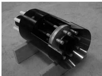
写真ー1 ウォータージェット併用刃口式推進とバキューム吸引排泥の組合せ
