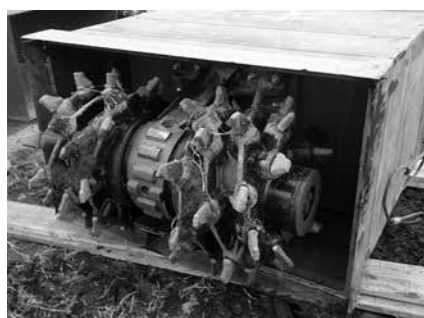
写真-8 ツインヘッドの取付け状況（前面）
