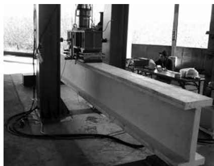
写真-3 曲げ試験状況
