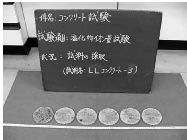
写真-1 浸漬によるコンクリート中の塩化物イオンの見掛けの拡散係数試験 (JSCE-G572-2007)
