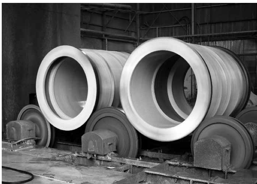
写真-1 40Gの高速回転で締め固め
