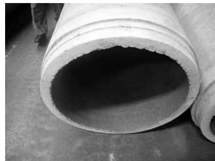
写真-3 ベトナムの外圧管端部（スピゴット）
