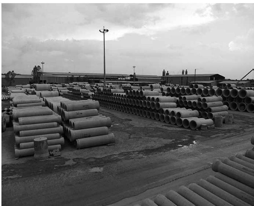
写真-4 ベトナムで生産されている外圧管（Hung Vuong 社工場）
