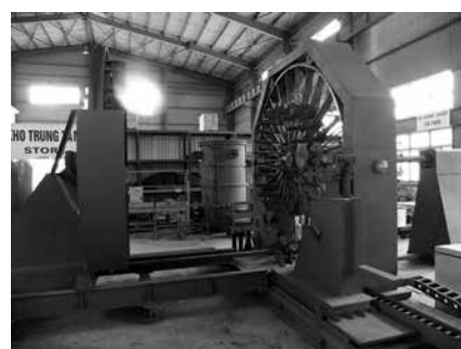
写真-5 機械設備メーカ視察状況 （ハノイ 鉄筋編成機）
