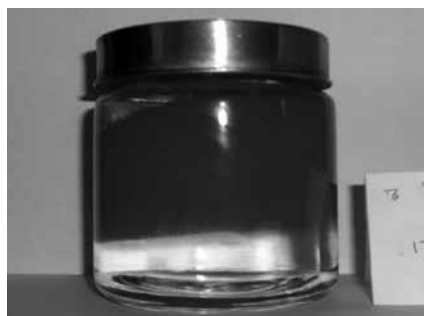
写真-1 一液性滑材を着色作液して、少量の水道水を注水した直後の状態
