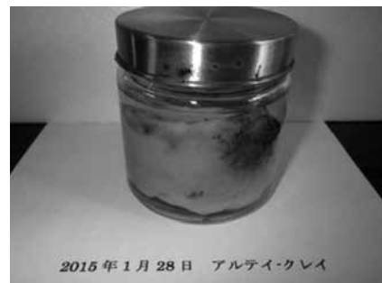
写真-4 アルティークレイ(海水中2年4箇月後) (海水内で2年以上経過後も溶出無く流動性を維持。表面には微が付着)
