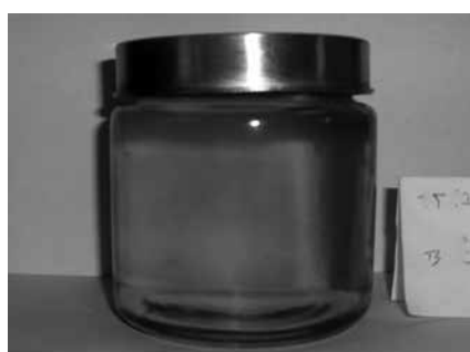
写真-2 写真-1の滑材の一週間後の状態 (水に溶出している)
