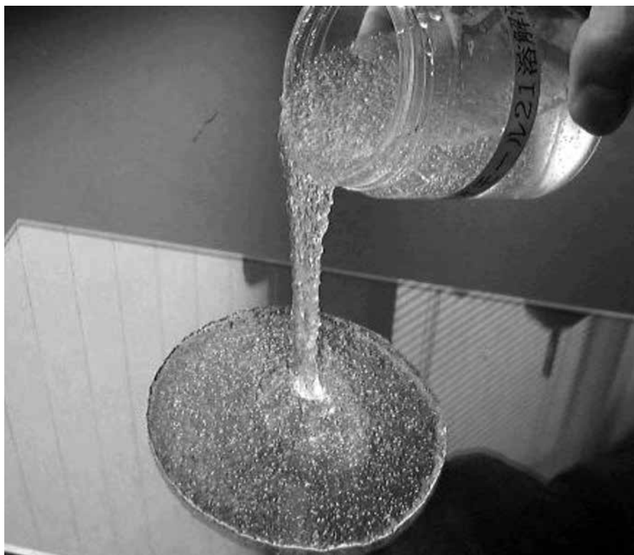
写真-3 ネオモール21の溶解液（滑材）
