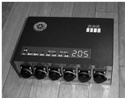
写真－1 通信ユニット (SB-1)
