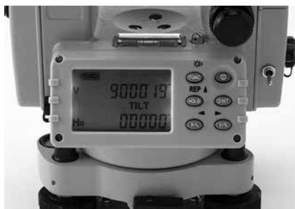
写真－3 改造した本体側スイッチ
