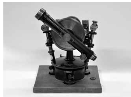
大正7年に陸地測量部から検定を受けた 玉屋製三等経緯儀 (Transit Theodolite)
