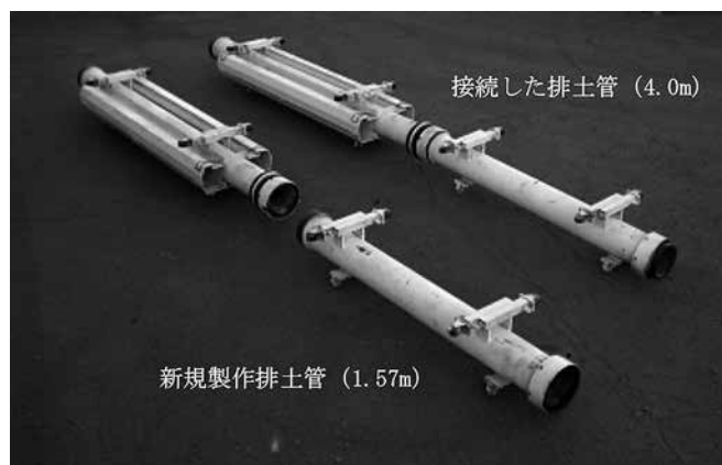
写真ー2 新規製作排土管と接続状況
