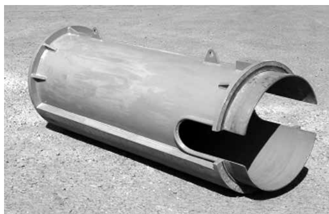
写真ー3 仮押管
