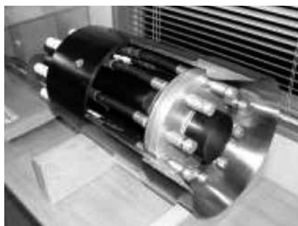
写真-1 PSS-Arch工法の掘削装置
