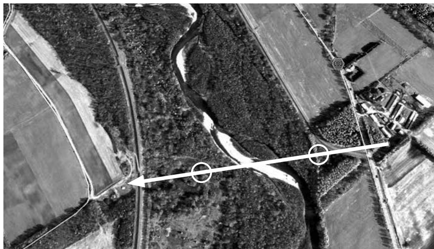
写真-1 札内川横断平面 (○印：ビット交換位置)
