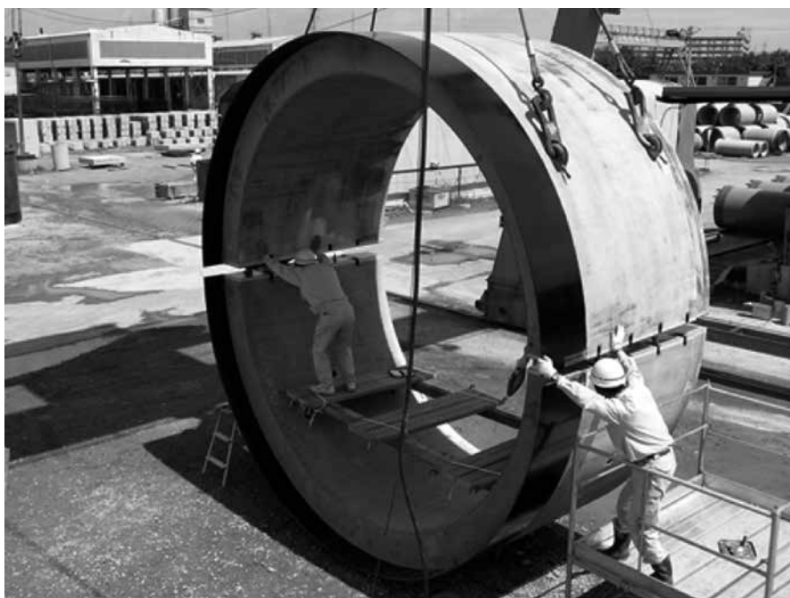
写真-1 超大口径推進管の開発
