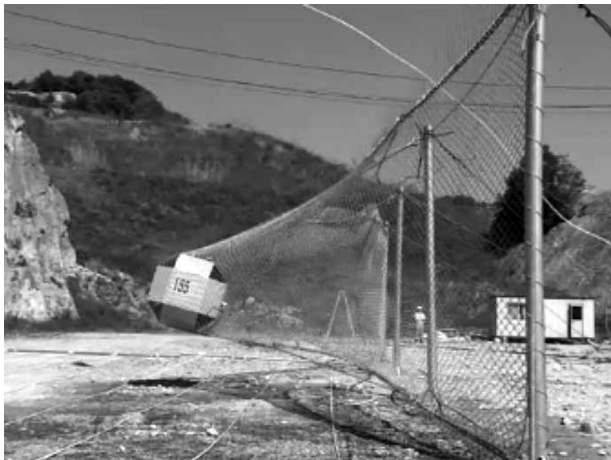
写真-2 防護柵の実物実験
