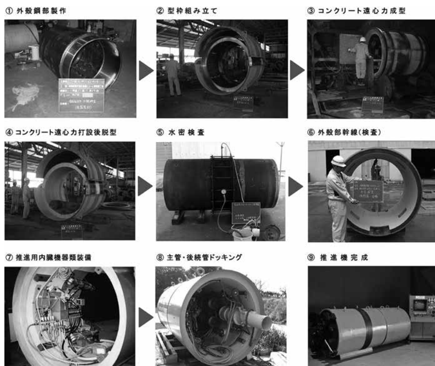
写真-1 掘進機製作工程
