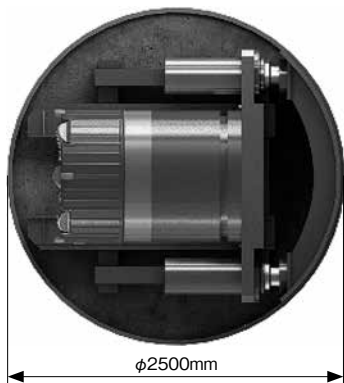
写真-1 小型立坑からの発進 (掘進機長L=2.0m)
