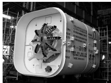
写真-3 アポロカッタ工法のシールド掘進機
