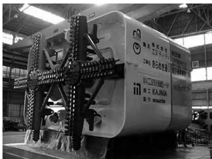
写真-1 WAC工法のシールド掘進機
