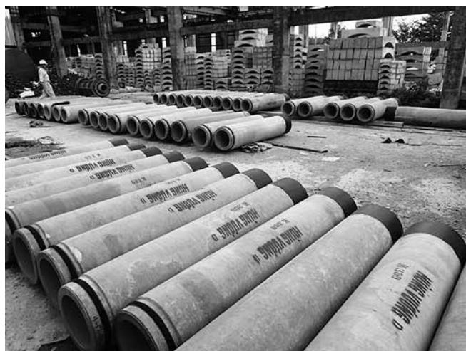
写真-2 ストック状況 (樹脂ライニング推進管)
