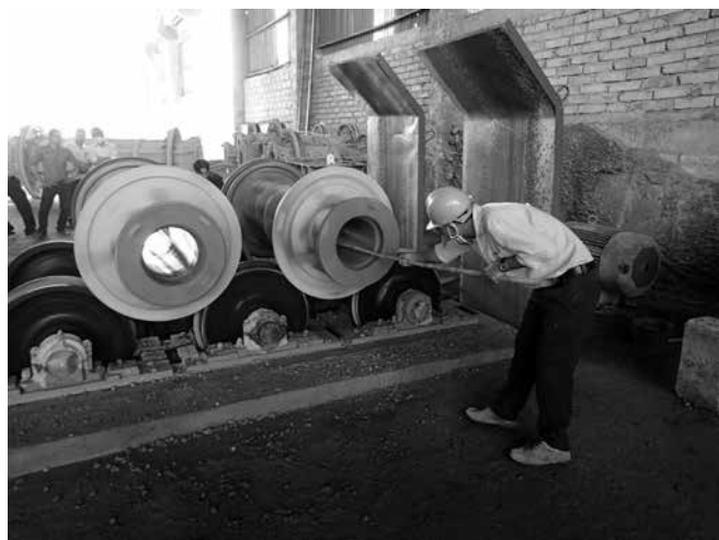
写真-1 推進管製造状況
