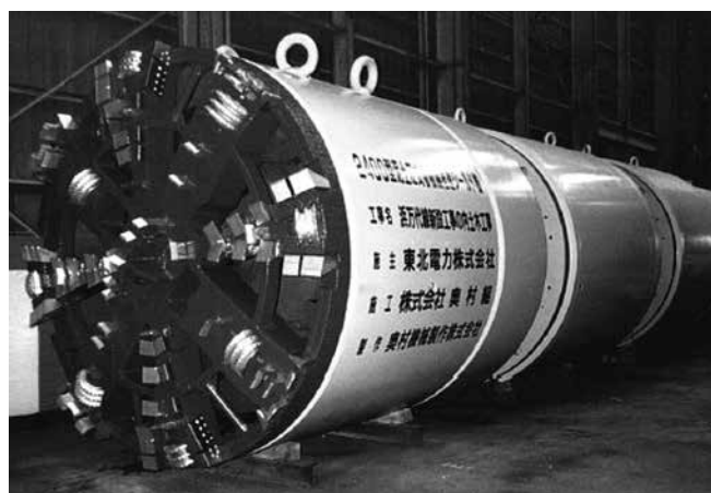
写真－１ 推進・シールド切換型工法掘進機
