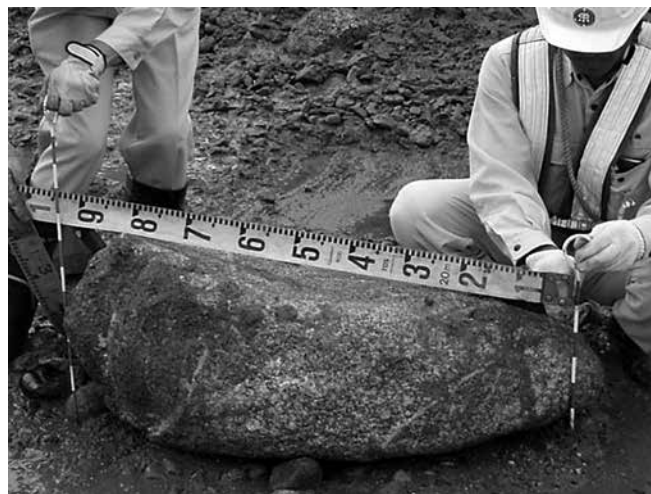
写真-2 到達立坑出現粗石（長径950mm）
