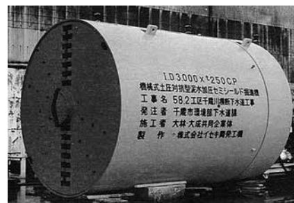
写真-1 呼び径3000機械式土圧対抗型 泥水セミシールド掘進機
