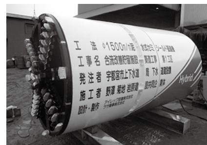
写真-1 掘進機外観
