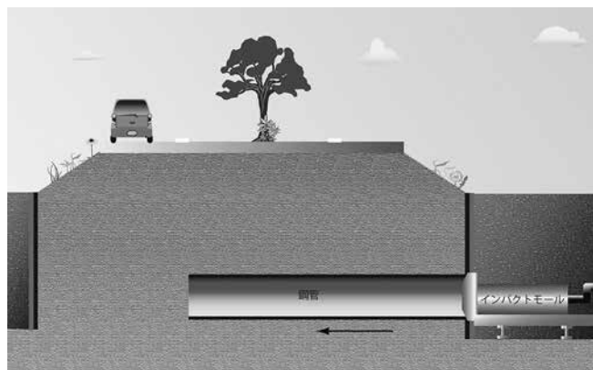
図-2 機械を後方に据付、鋼管を圧入させる
