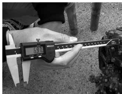
写真-4 チップの磨耗をチェック
