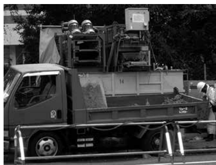
写真-3 マイクロセパレーター
