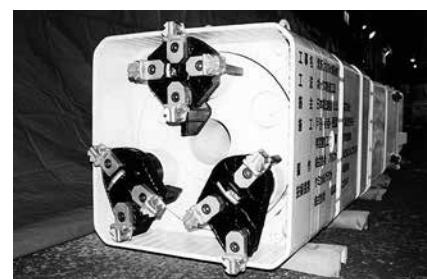
写真-3 使用したボックス掘進機
