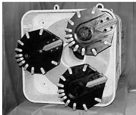
写真-1 ボックス掘進機1号機
