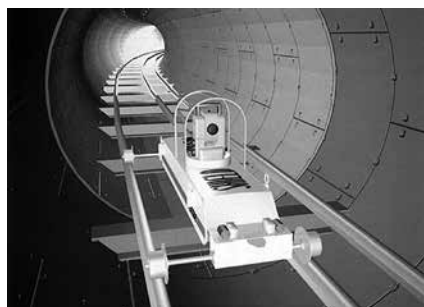
図-2 シールドナビゲーター 出典：自動測量研究会HP
