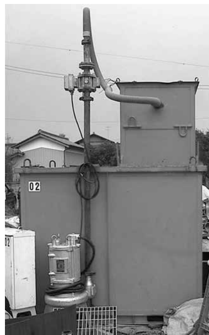
写真-1 沈殿分級型泥水処理プラント
