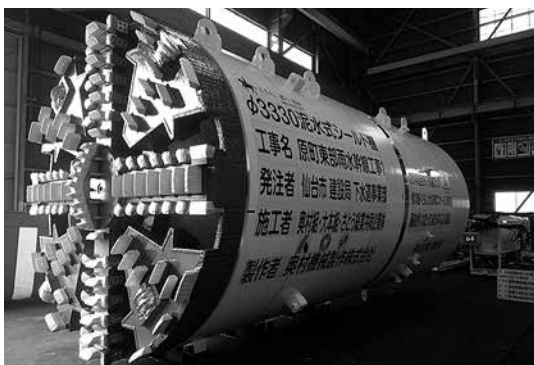
写真-2 原町東部雨水幹線工事1シールドマシン
