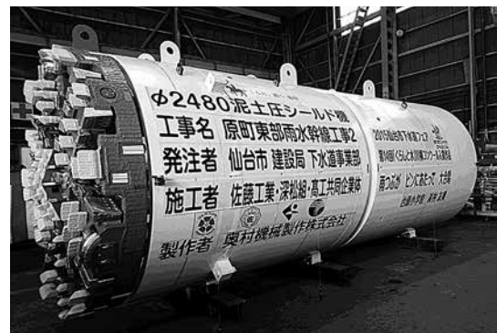
写真-3 原町東部雨水幹線工事2シールドマシン
