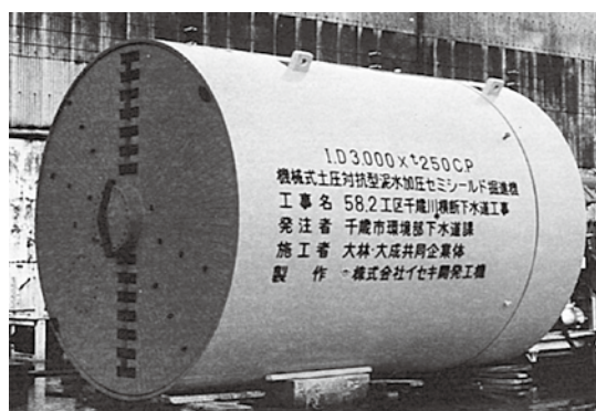
写真-1 機械式土圧対抗型泥水加压セミシールド掘進機
