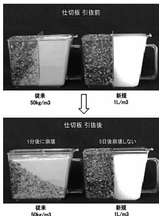
写真-2 崩壊試験状況
