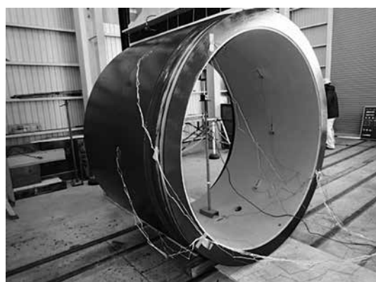
写真－5 ひずみゲージ取付け状況
