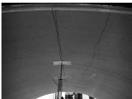
写真－4 MAX推進管の破壊試験状（試験終了時）
