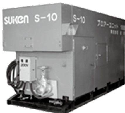
写真－3 ブローユニット
