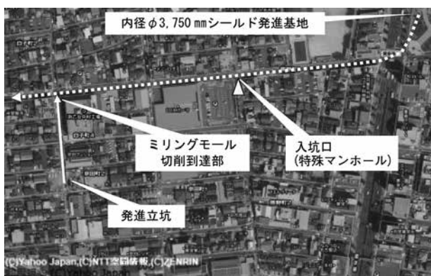
図-2 ミリングモール工法 施工平面図
